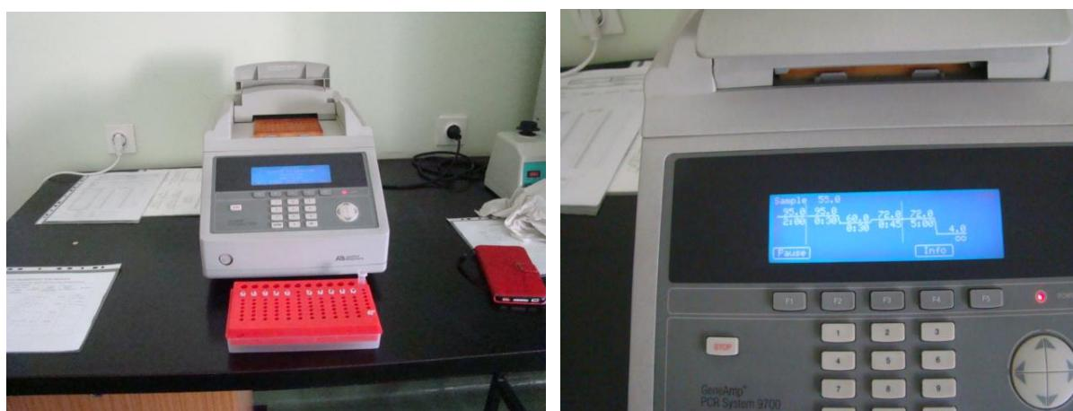
Umniožavanje ciljnog dijela DNA u uređaju GenAmp System 9700 (Applied Biosystems, SAD)
