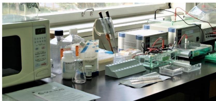
Slika 4.7. Sustav za elektroforezu PCR produkata na agaroznom gelu (SCI PLAS, UK)
