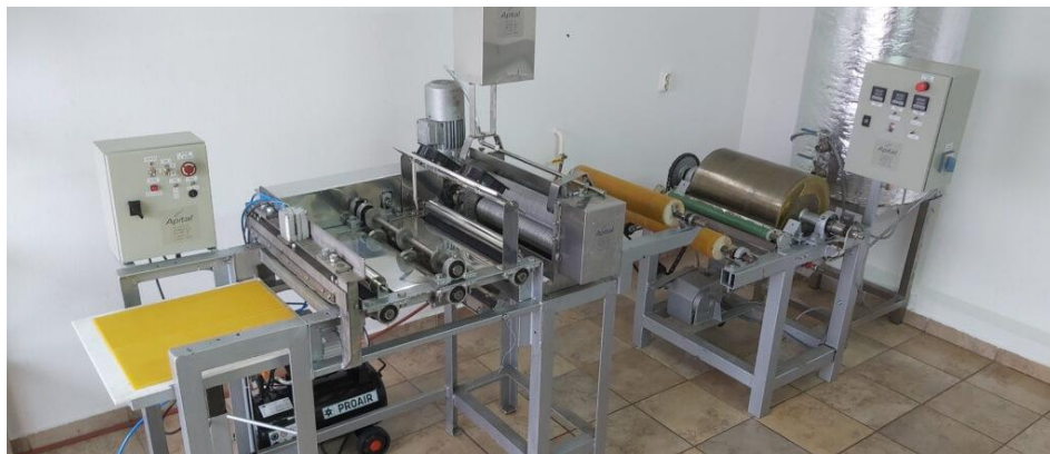
Slika 6. Valjci za proizvodnju satnih osnova ( https://satne-osnove.hr/ ).
