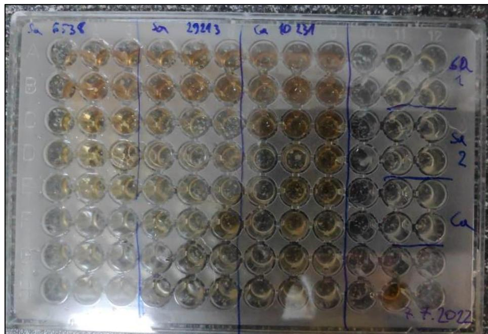
Slika 2. Mikrotitarska pločica korištena za određivanje MIK-a.
