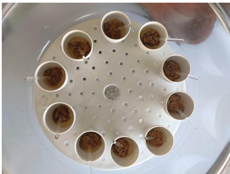
Slika 3. Sušenje uzoraka u eksikatoru
