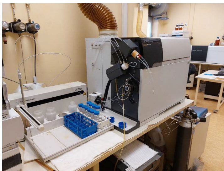
Slika 16. Uređaj ICP-MS Agilent system Model 7900.
