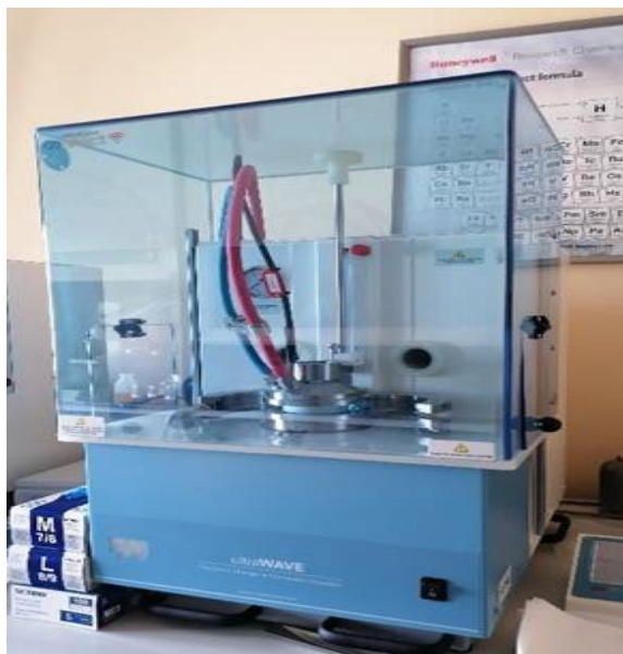
Slika 15. Ultra WAVE ECR mikrovalna pećnica.
