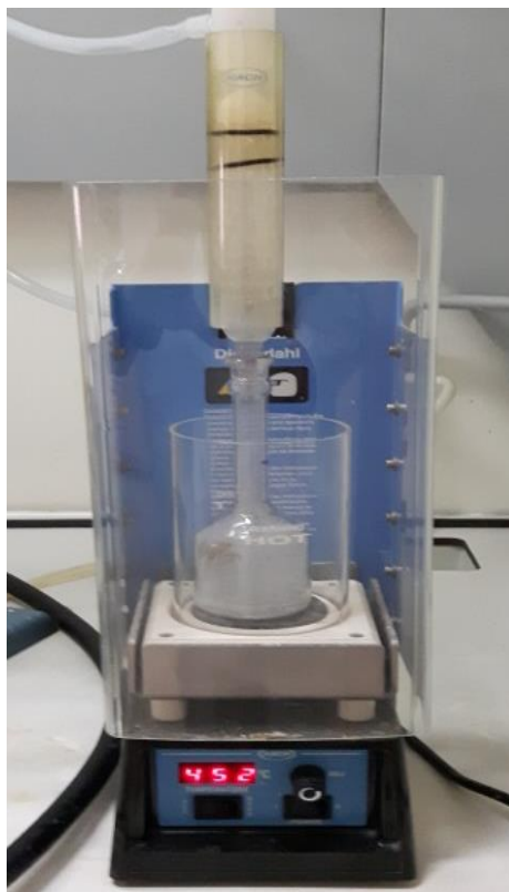
Slika 3. HACH aparat za razaranje uzorka
