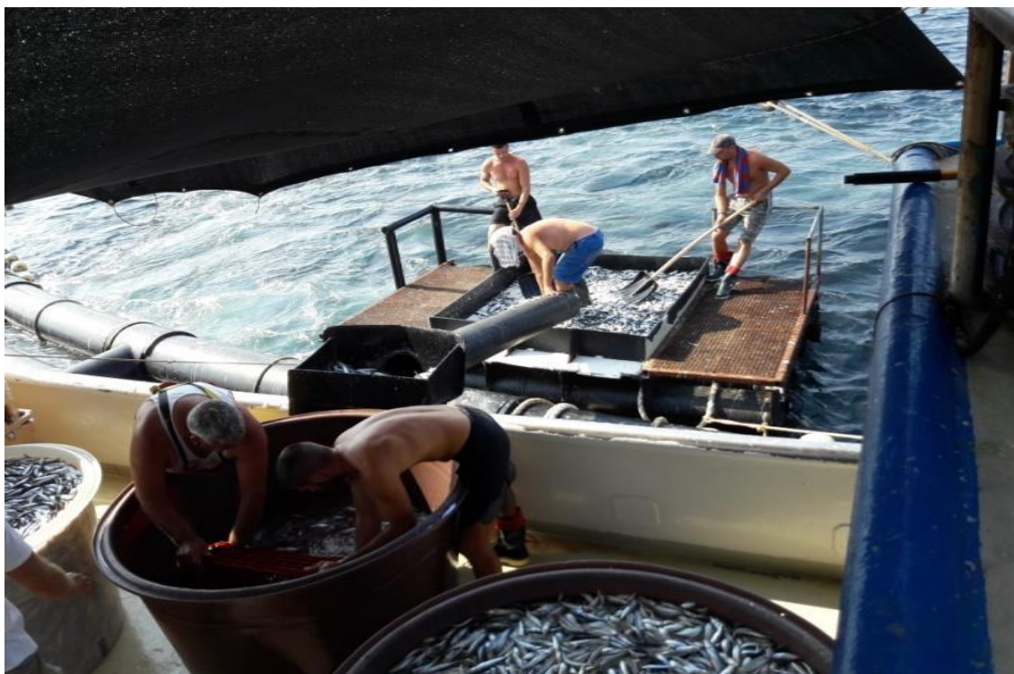
Slika 6. Prijenos hrane na plutajuću platformu usipnom cijevi.
