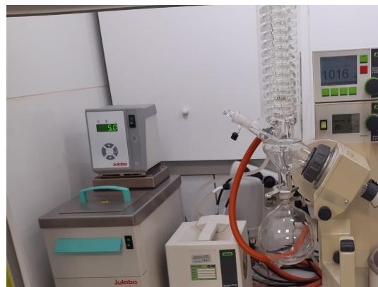
Slika 8. Rotacijski evaporator
