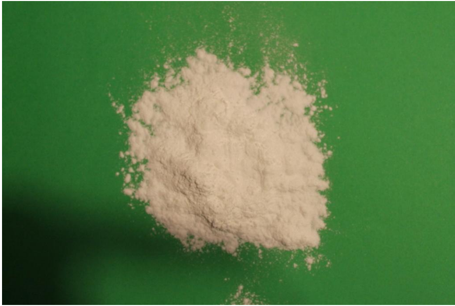
Slika 9. Uzorak suhe biomase \beta -glukana u obliku topivog praška (broj formule F3020, broj proizvoda 08231-01) izdvojenog iz ne-GMO soja pekarskog kvasca S. cerevisiae proizvođača Biothera (Eagan, MN, SAD).
