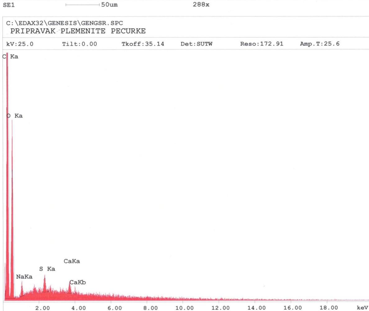
Slika 19. Elementna kemijska analiza uzorka pripravka plemenite pečurke na prisustvo teških metala rađenej na elektronskom mikroskopu SEM-u Philips XL 30 s EDX detektorom (EDAX), aktivne površine  $10\text{mm}^2$  (Centar za forenzična ispitivanja, istraživanja i vještačenja Ivan Vučetić, Zagreb, Hrvatska).
