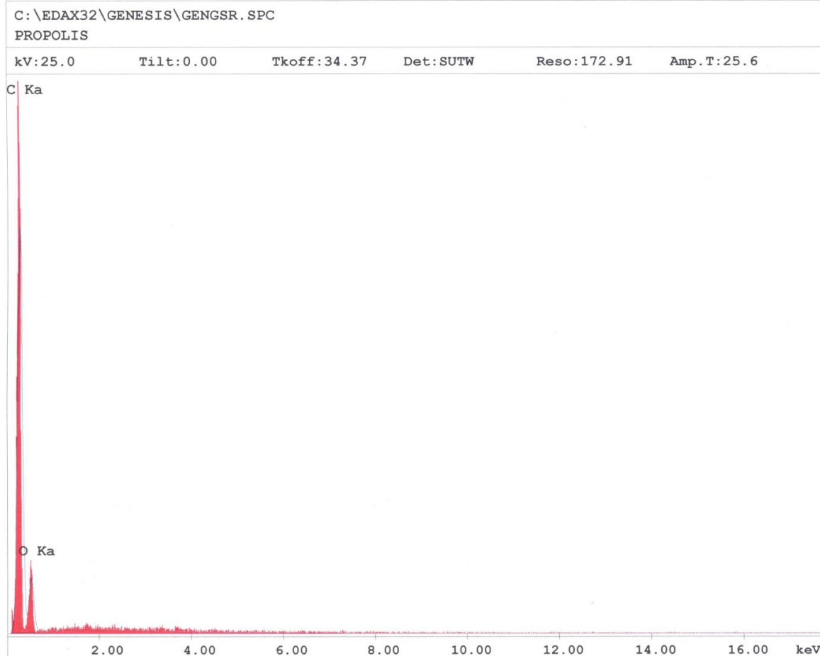
Slika 18 . Elementna kemijska analiza uzorka nativnog propolisa na prisustvo teških metale rađene na elektronskom mikroskopu SEM-u Philips XL 30 s EDX detektorom (EDAX), aktivne površine 10mm 2 (Centar za forenzična ispitivanja, istraživanja i vještačenja Ivan Vučetić, Zagreb, Hrvatska).
