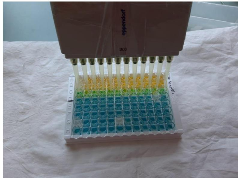
**Slika 4.** Mikrotitracijska plitica tijekom dodavanja stop otopine
