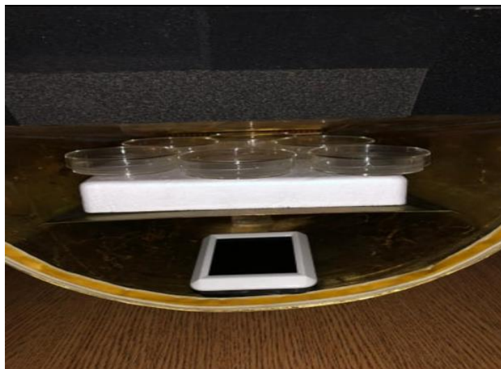
Slika 7. GTEM komora. Prikaz GTEM komore u kojoj su smješteni uzorci spermija nerasta zajedno sa digitalnim termometrom. (fotografirao dr.sc. Ivan Butković, dr. vet. med.).
