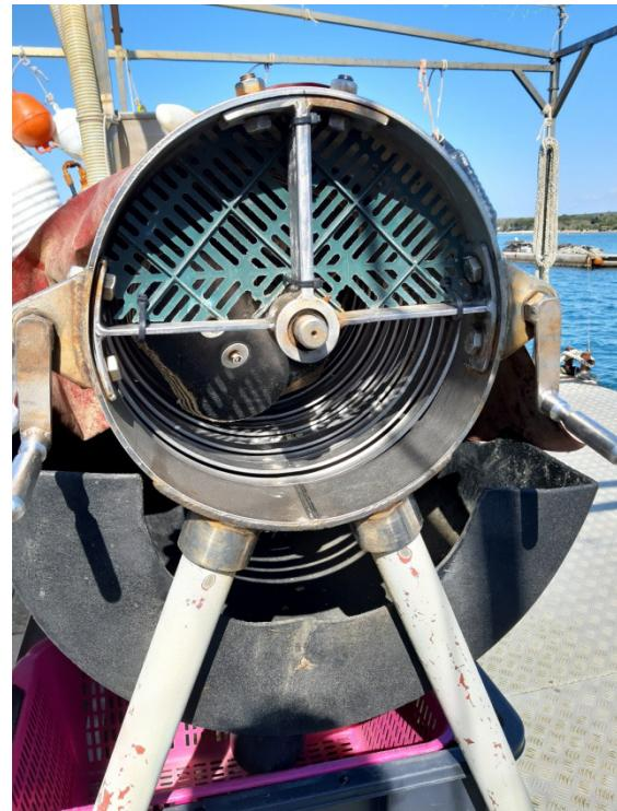
Slika 14. Izlazni otvor uređaja za pranje i sortiranje (foto: N. Džafić)
