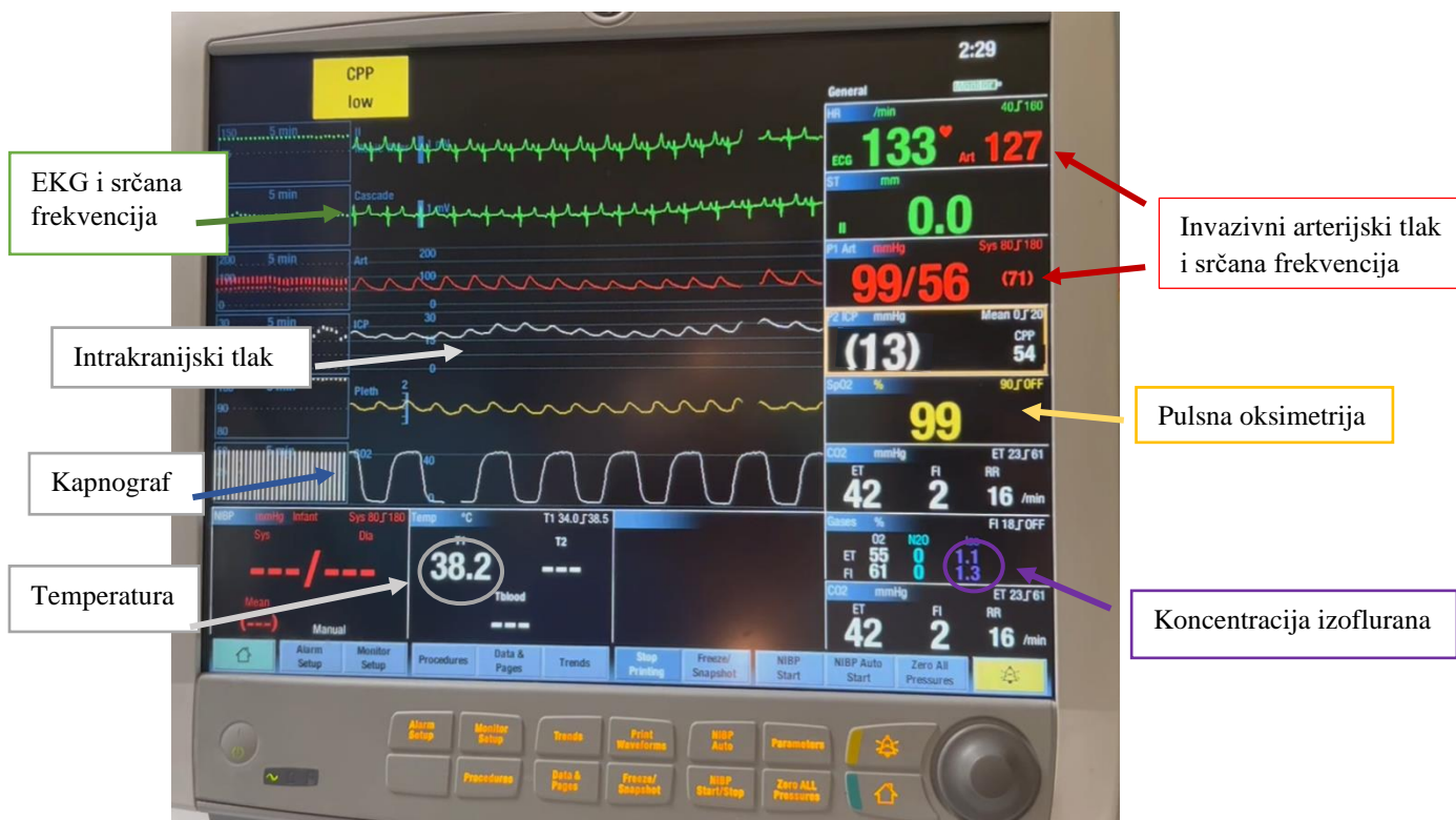
Slika 4.2. Multiparametrijski anesteziološki monitor za praćenje vitalnih parametara svinja. Zelena boja označava EKG i srčanu frekvenciju koju on očitava. Crvena krivulja označava pulzaciju u arteriji te daje očitavanja invazivno mjenog arterijskog tlaka, kao i srčanu frekvenciju. Gornja bijela krivulja prikazuje mjerenje intrakranijskog tlaka. Žutom bojom označene su vrijednosti pulsne oksimetrije. Donja bijela boja označava krivulju kapnografa, dok brojčane vrijednosti označavaju frekvenciju disanja i izdahnuti CO 2 . Temperatura je prikazana u donjoj trećini ekrana, također iskazana bijelom bojom. Ljubičastom bojom označene su udahnuta i izdahnuti koncentracija inhalacijskog anestetika izoflurana.
