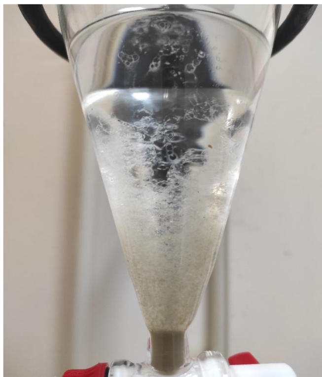
Slika 4. Odvajanje otapala u tikvici za ekstrakciju
