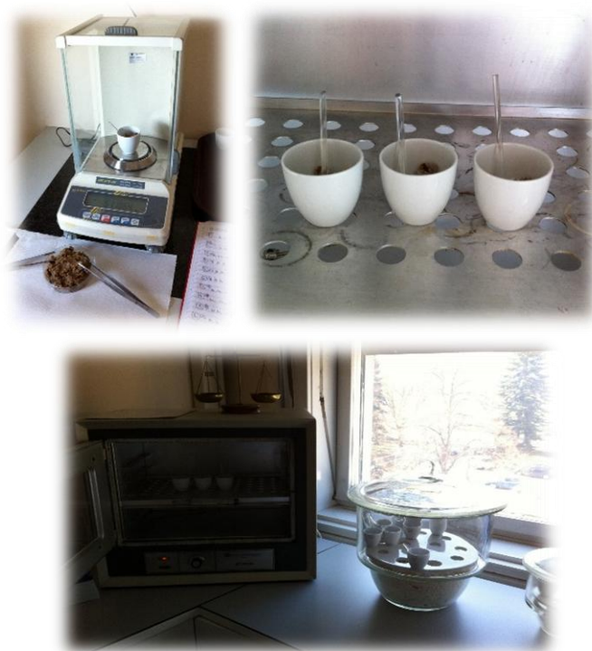
Slika 10. Postupak određivanja količine vode (Foto: Stefani Levak)
