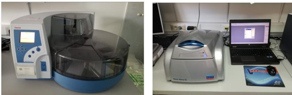
Slika 6. KingFisher Flex uređaj za izolaciju nukleinskih kiselina (lijevo) i uređaj RotorGene Q za izvođenje metode RT-PCR u stvarnom vremenu. (Autor: Sofija Džakula)
