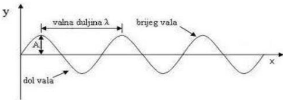
Slika 5. Sinusoidalni val
