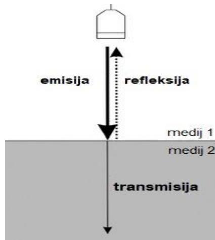
Slika 11. Shematski prikaz transmisije
