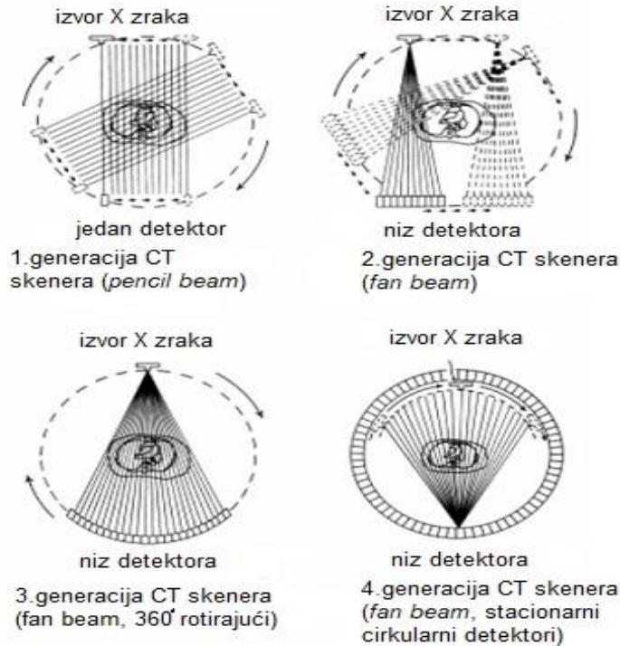
Slika 71. Shematski prikaz prve četiri generacije CT skenera
