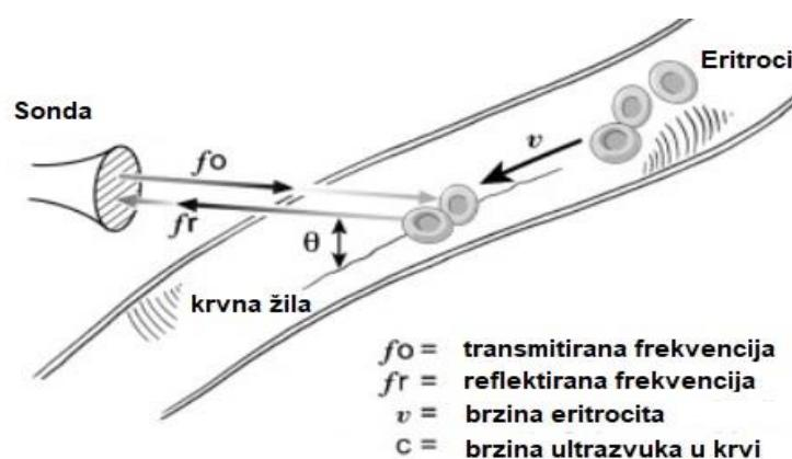
Slika 37. Shematski prikaz Doppler načina rada
