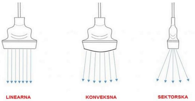
Slika 27. Osnovne vrste sonda
