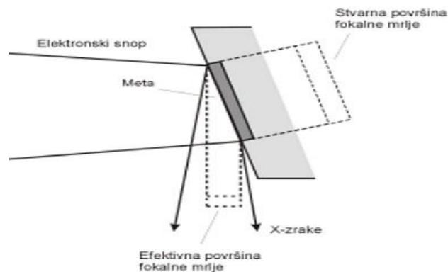
Slika 58. Shematski prikaz smanjivanja površine fokalne mrlje
