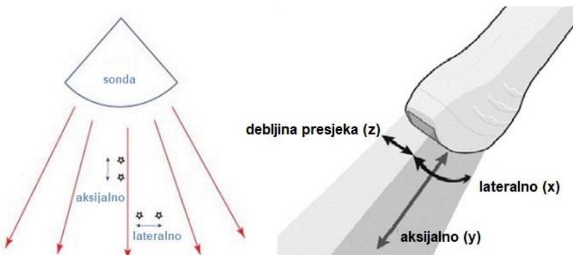
Slika 26. Shematski prikaz ultrazvučnog snopa i rezolucija
