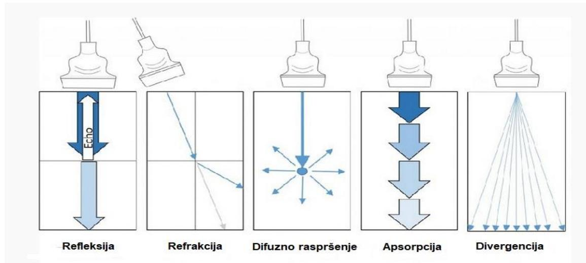
Slika 7. Oblici atenuacije ultrazvučnog vala u tkivu
