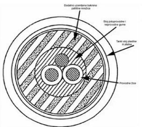
Slika 51. Strujni kabel (lijevo) i presjek kabela (desno)
