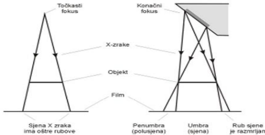
Slika 57. Shematski prikaz točkastog izvora (lijevo) i fokalne mrlje (desno)
