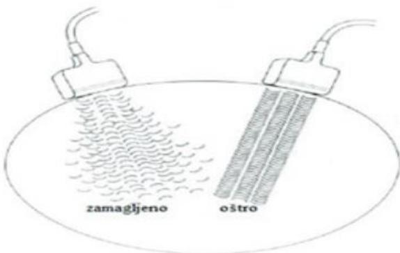
Slika 32. Kolimirani (desno) i nekolimirani (lijevo) ultrazvučni snop
