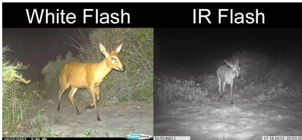
Slika 4. Noćna fotografija u boji dobivena korištenjem bijele bljeskalice (lijevo); crno-bijela noćna fotografija dobivena korištenjem infracrvene bljeskalice (desno)
