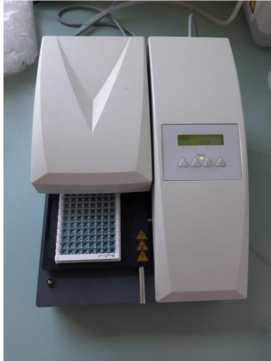
Slika 2. Ispiranje jažica mikrotitracijske plitice u automatskom ispiraču mikrotitracijskih plitica
