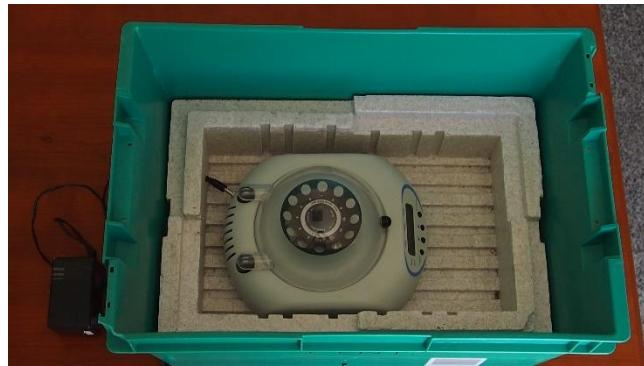
Slika 8. Centrifuga za Eppendorf epruvete
