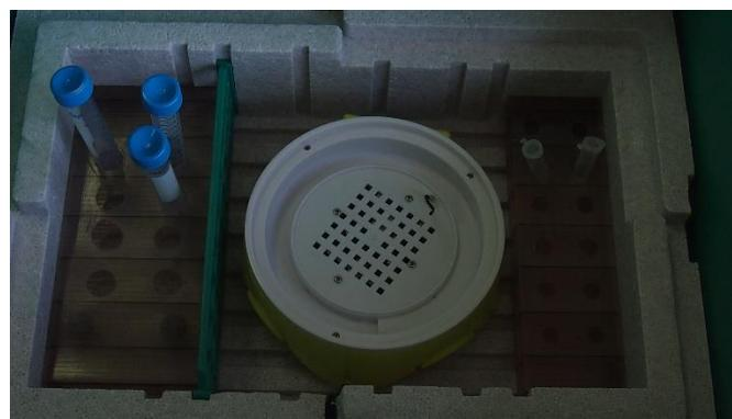
Slika 7. Prijenosni inkubator za održavanje optimalne temperature
