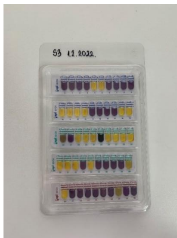
Slika 1. API 50 CHL dijagnostički test
