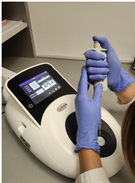
Slika 11. Određivanje koncentracije bakterijske DNK na BioDrop mikrovolumnom spektrofotometru
