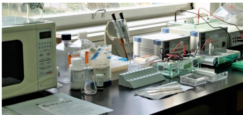
Slika 4.7. Sustav za elektroforezu PCR produkata na agaroznom gelu (SCI PLAS, UK) Zavod za anatomiju, histologiju i embriologiju, Veterinarski fakultet Sveučilišta u Zagrebu
