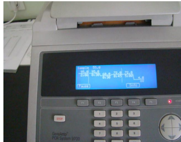
Umnožavanje ciljnog dijela DNA u uređaju GenAmp System 9700 (Applied Biosystems, SAD)
