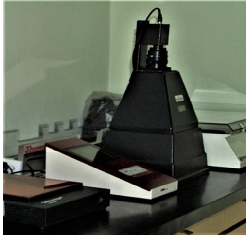
Slika 4.8. UV transiluminator s plavim svjetlom (Safe imager, Invitrogen) i kamera (Uvitec, UK) Zavod za anatomiju, histologiju i embriologiju, Veterinarski fakultet Sveučilišta u Zagrebu
