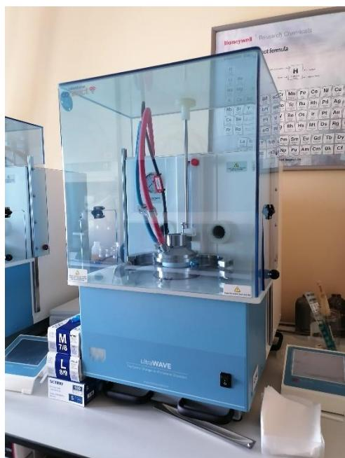
**Slika 9.** UltraWAVE ECR MW pećnica.
