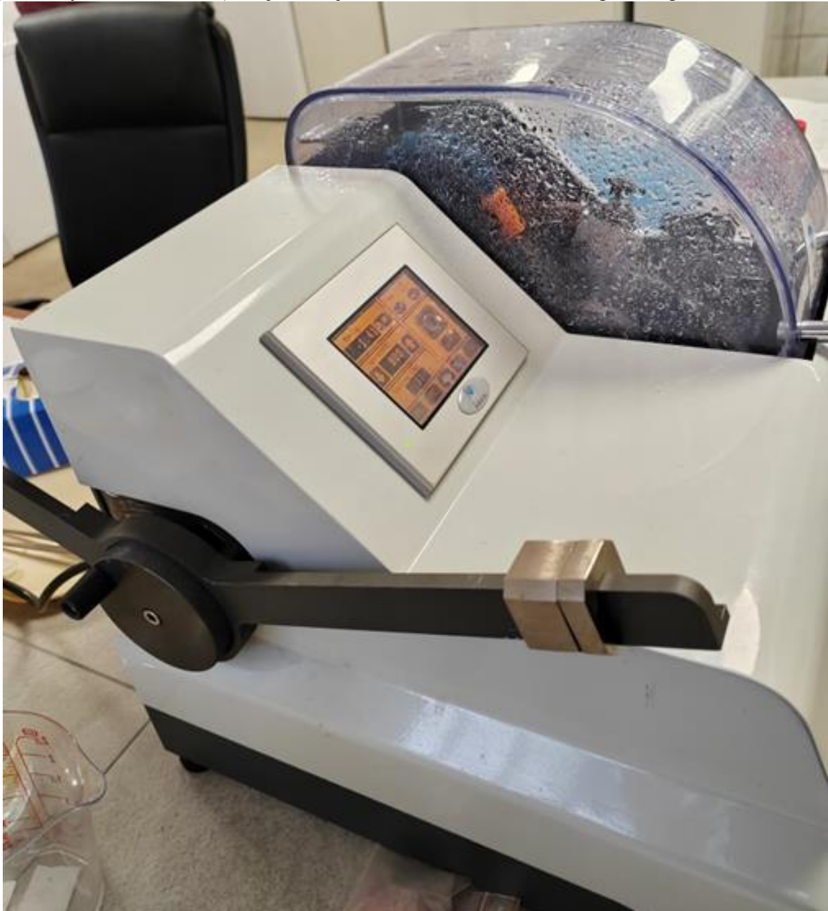
Slika 8. Dijamantna rezalica. (foto: V. Turk).
