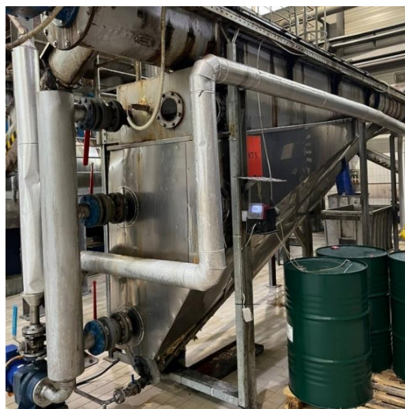
Slika 22. Separator pogona za preradu materijala kategorije 1 i 2 (foto: Josipa Lovasić)
