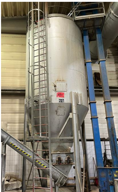
Slika 27. Silos za skladištenje mesno-koštanog brašna (foto: Josipa Lovasić)
