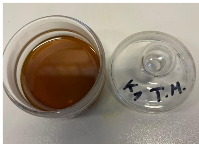
Slika 37. Tehnička mast (foto: Josipa Lovasić)
