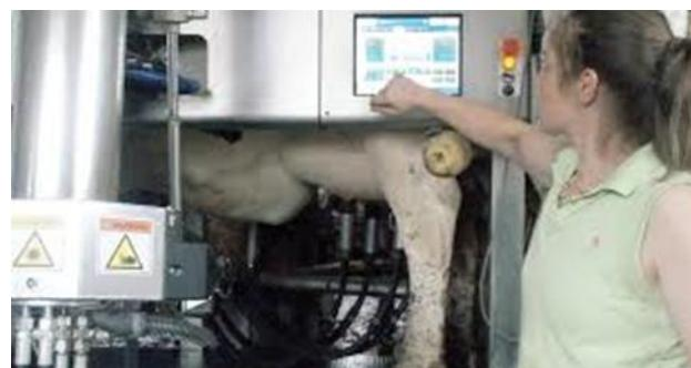
Slika 7. Robot za mužnju tvrtke DeLaval.
