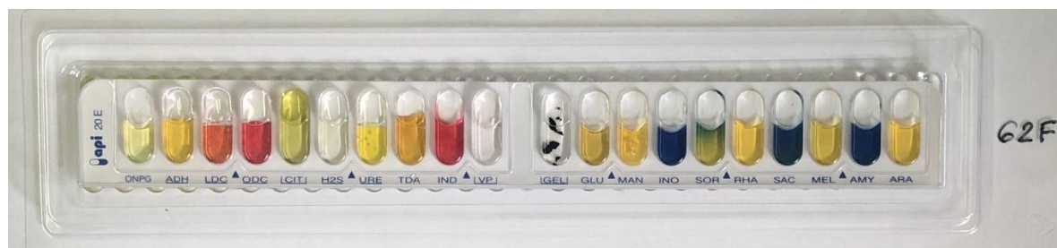
Sika 5. API 20E niz nakon inkubacije i dodavanja reagensa (ornitin-dekarboksilaza pozitivan i saharoza negativan izolat 62F).
