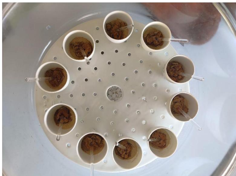
Slika 3. Sušenje uzorka u eksikatoru
