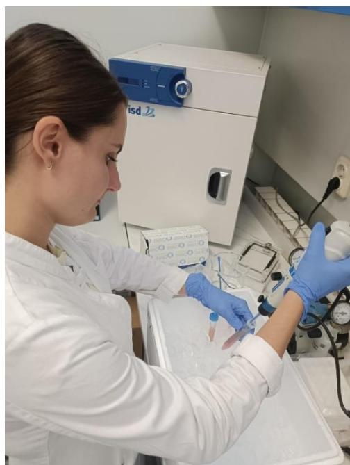
Slika 5. Priprema uzorka za detekciju B12 vitamina ELISA metodom
