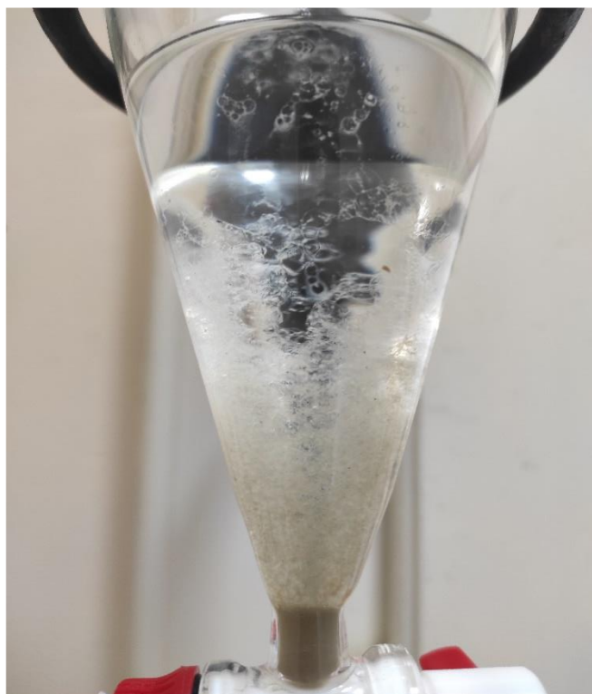
Slika 4. Odvajanje otapala u tikvici za ekstrakciju
