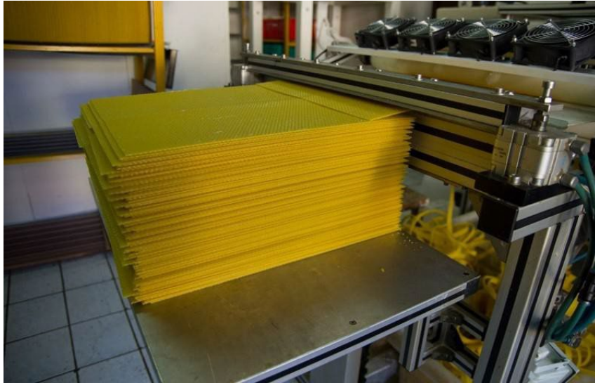
Slika 12. Izrađene satne osnove izrezane na veličinu okvira u koji će se užičavati.
