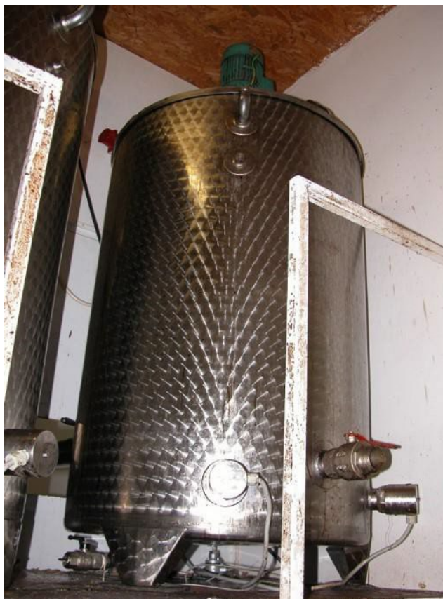
Slika 9. Čelični spremnik za preradu voska (TLAK GAJGER, 2015.).
