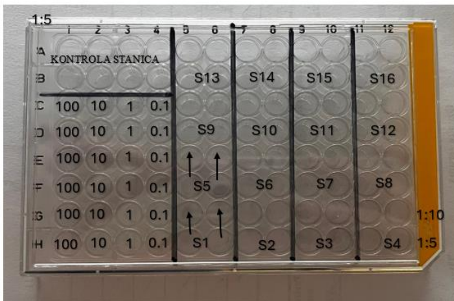
Slika 9. Prikaz početne mikrotitracijske plitice screening testa. Označena su područja kontrole stanica, deseterostrukih uzastopnih razrjeđenja standardne virusne doze (100/10/1/0.1) i pretraživanih seruma (S1 do S16).
