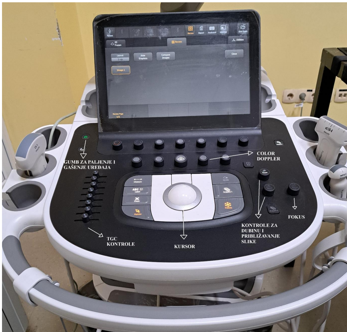
Slika 2. Dijelovi kontrolne ploče. TGC (engl. Time-gain compensation control ), Kontrola vremenske kompenzacije
