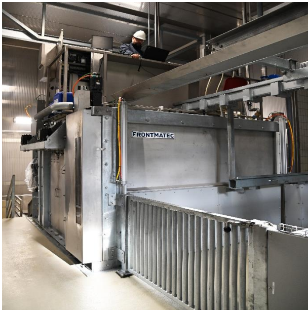
Slika 7. Gondola za omamljivanje (PIK Vrbovec plus d.o.o.)
