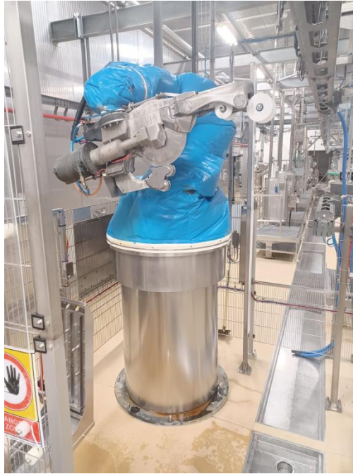
Slika 4. Prikaz robota za rasijecanje trupova (PIK Vrbovec plus d.o.o.)
