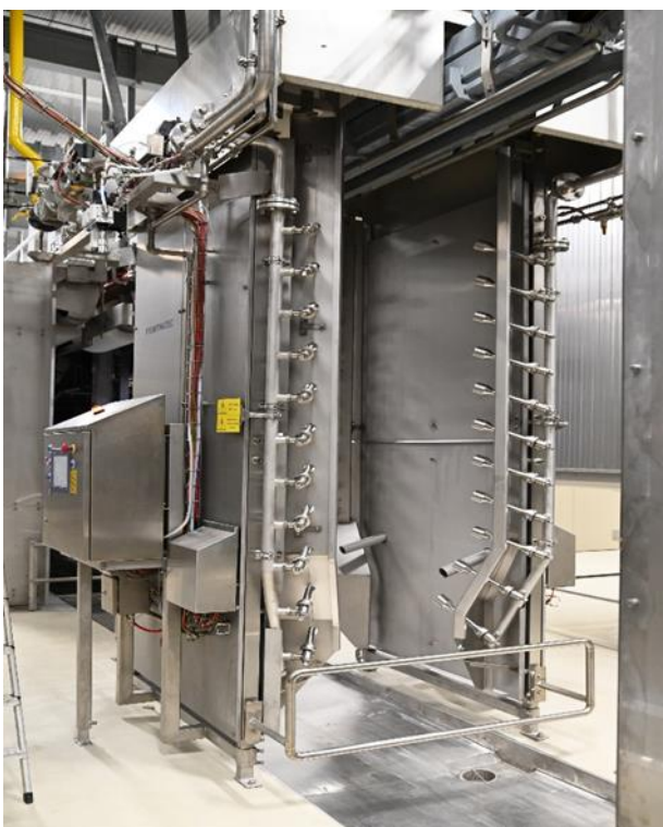
Slika 17. Uređaj za plinsko opaljivanje (PIK Vrbovec plus d.o.o.)
