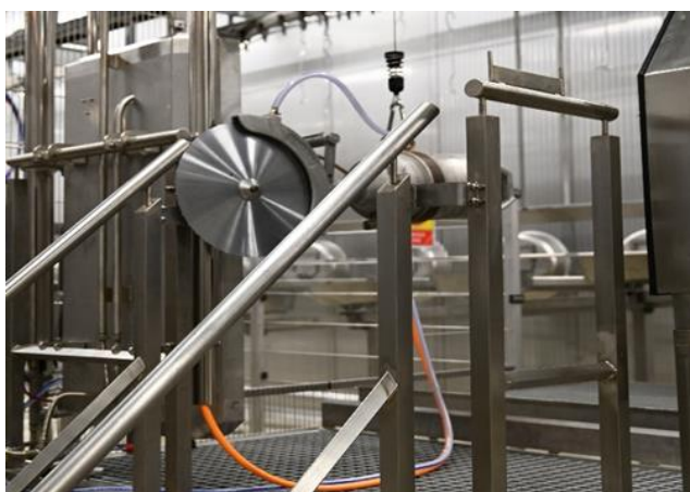
Slika 24. Pomoćna pila za rasijecanje trupova (PIK Vrbovec plus d.o.o.)
