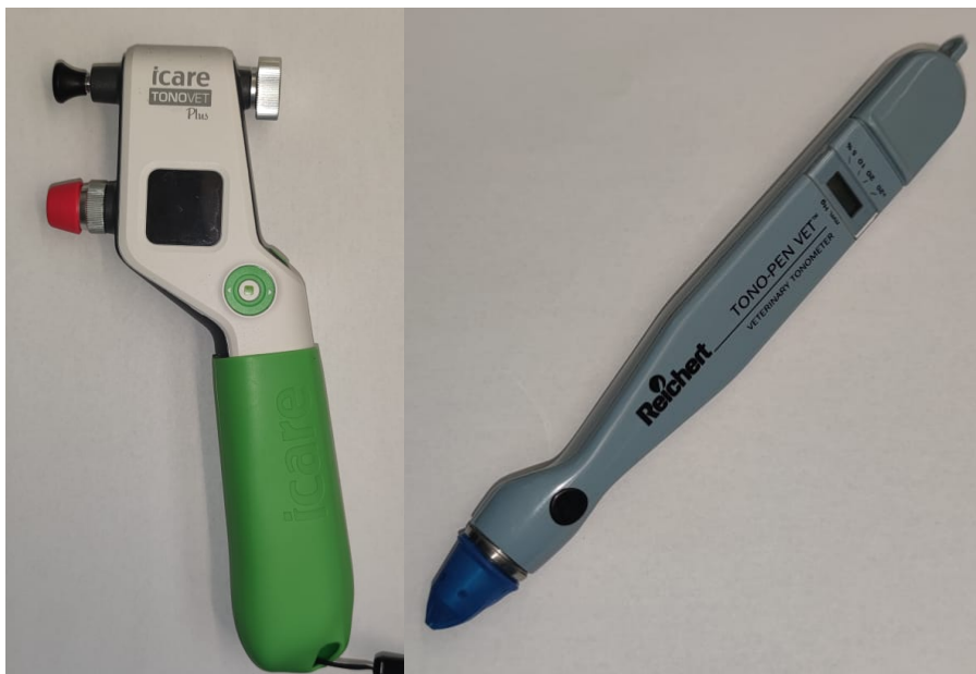
Slika 2. A Povratni tonometar iCare 2. B Aplanacijski tonometar (Reichert) (izvor: arhiva Klinike za kirurgiju, ortopediju i oftalmologiju Veterinarskog fakulteta Sveučilišta u Zagrebu)
