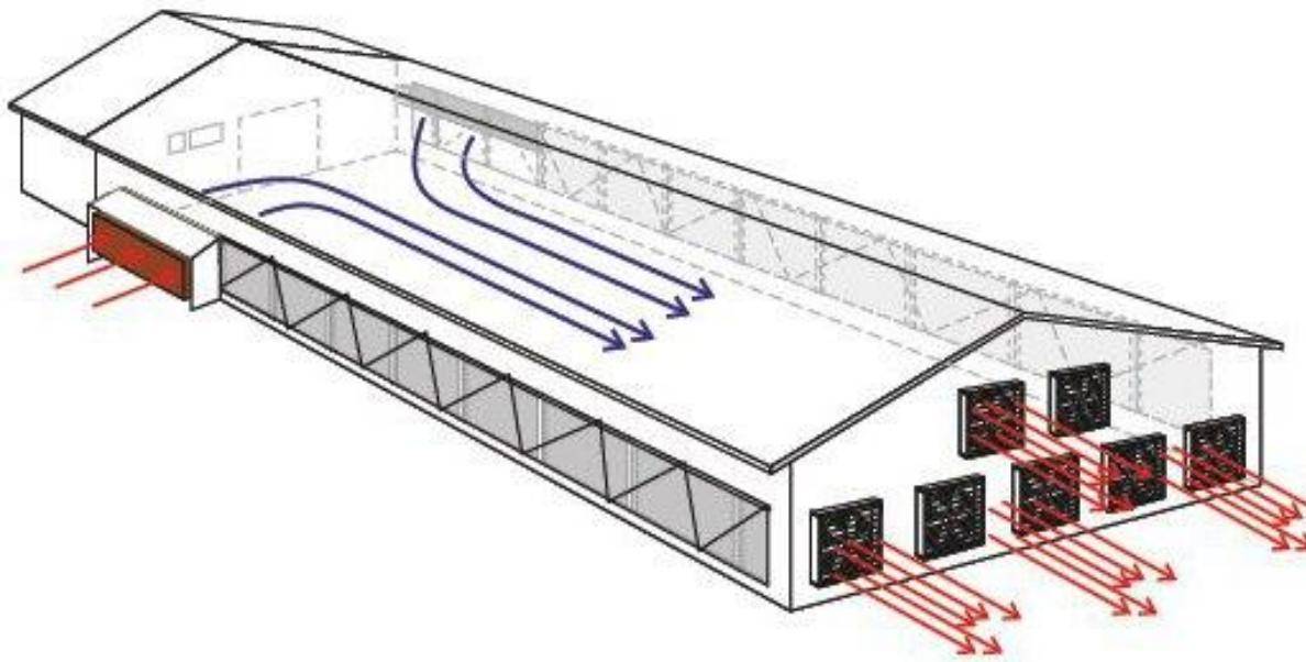
**Slika 4.** Prozračivanje na podtlak – tunelski tip
