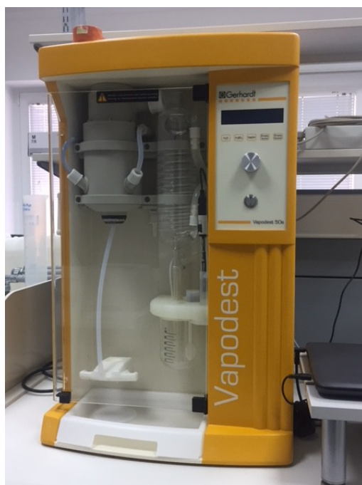
Slika 4.: Uređaj za destilaciju i titraciju, Gerhardt, Vapodest 50s
