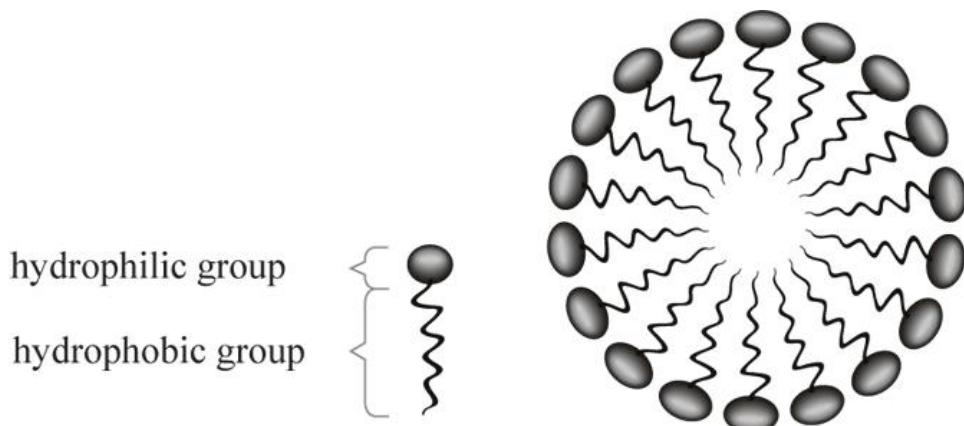
Slika 14. Shematski prikaz građe micele. [Preuzeto sa URL: <http://eng.thesaurus.rusnano.com/upload/iblock/383/micelle1.jpg>]
