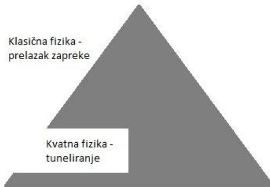
Slika 3. Efekt tuneliranja – Prema zakonu klasičnoga mehaničkog modela, kako bi elektron svladao određenu energijsku prepreku, mora imati kinetičku energiju veću od energije prepreke. Na nanoskali to nije slučaj, kvantno mehanički model omogućuje elektronima tuneliranje.
