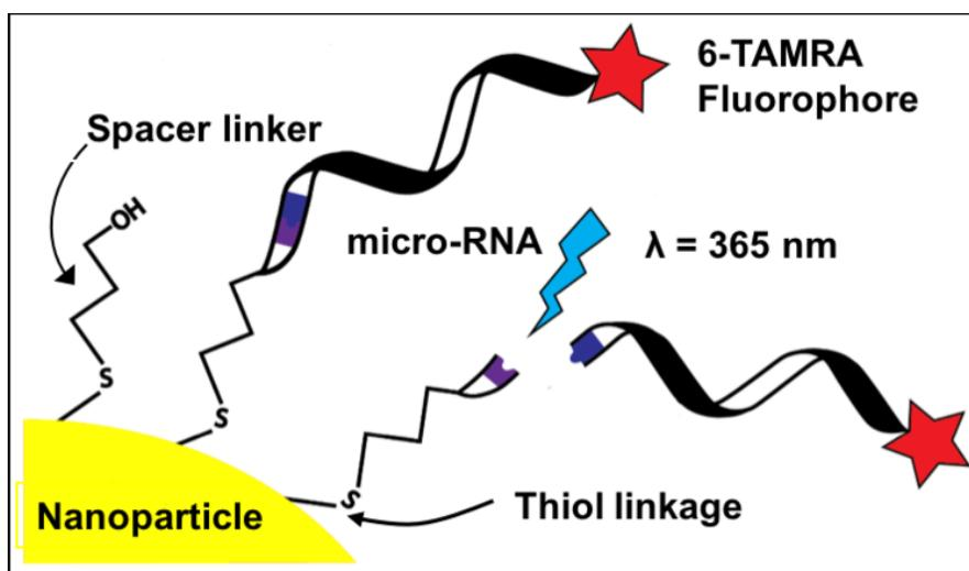
Slika 12. Shematski prikaz otpuštanja lijeka iniciran svjetlom. Lijek je vezan na nanočesticu pomoću linkera. Kada nanomaterijal osvijetlimo ultraljubičastim svijetлом (plava munja), veza imēđu lijeka i nanočestica puca i
