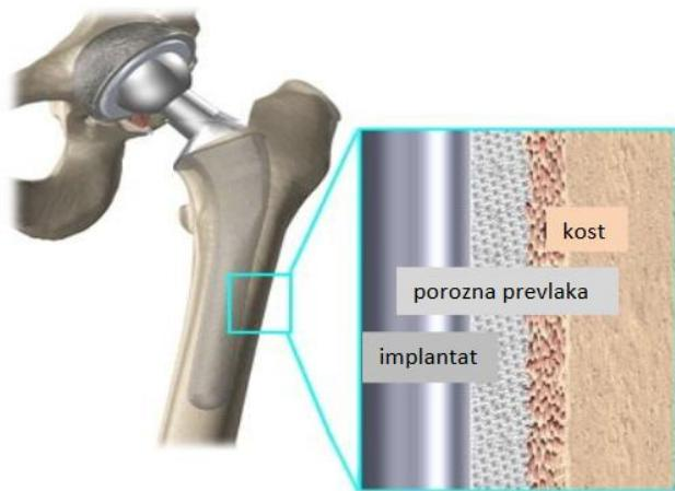
Slika 6. Hidroksiapatit je odličan izbor na poroznu prevlaku. Bioaktivran je te uspostavlja vezu s okolnim tkivom.
