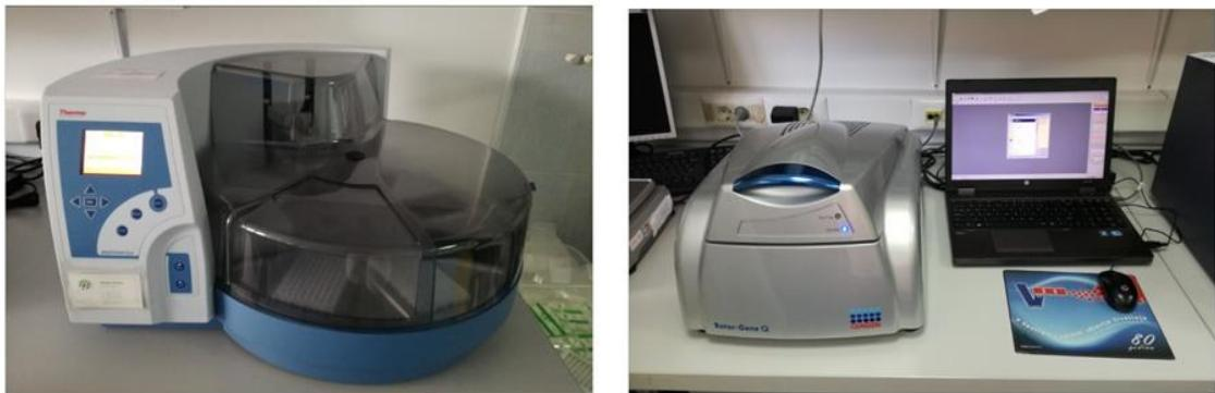
**Slika 6.** KingFisher Flex uređaj za izolaciju nukleinskih kiselina (lijevo) i uređaj RotorGene Q za izvođenje metode RT-PCR u stvarnom vremenu. (Autor: Sofija Džakula)
