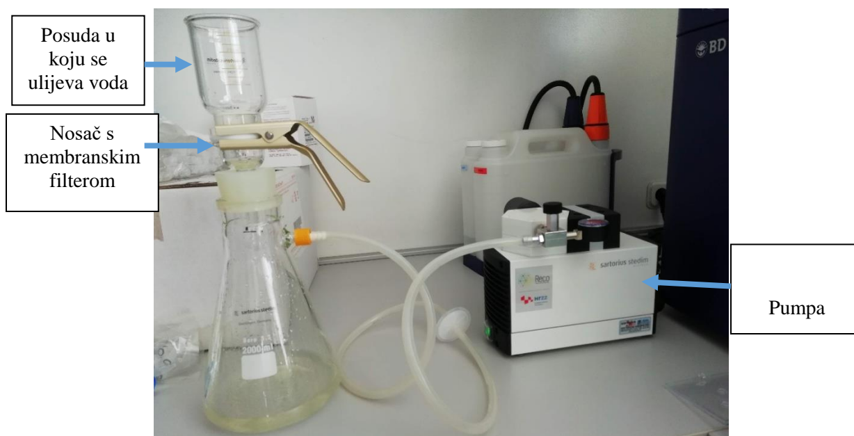
Slika 5. Sustav za filtraciju vode
