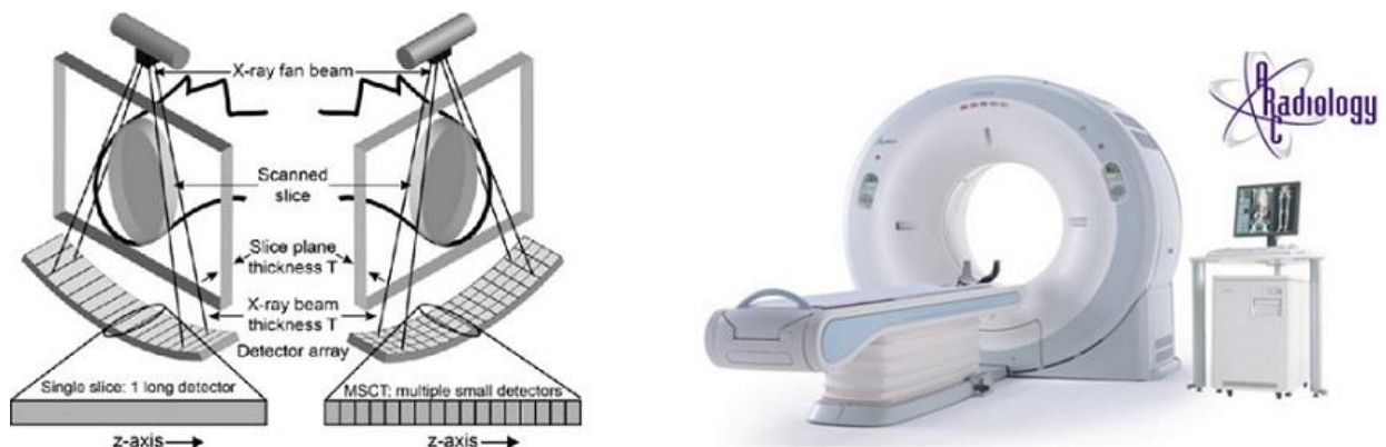
Slika 75. Shematski prikaz razlika kod MSCT-a (lijevo) i MSCT skener (desno)
