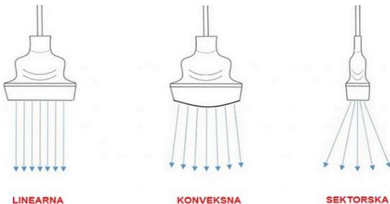
Slika 27. Osnovne vrste sonda
