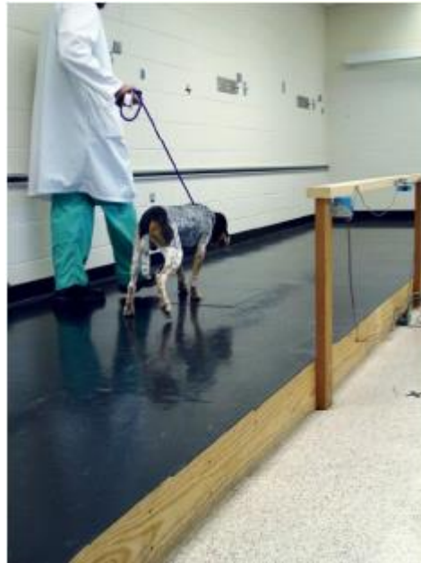
Slika 4. Pas hoda po ploči koja mjeri sile reakcije tla (preuzeto iz Weigel i Millis, 2014.)
