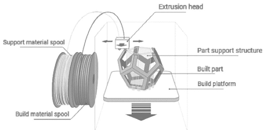
Slika 1. Shematski prikaz FDM metode ispisa (WEI i sur., 2017.). Dijelovi ispisivača: build material spool – filament gradivnog materijala; support material spool – filament potpornog materijala; extrusion head – mlaznica; part support structure – dio potorne strukture; built part – ispisani model; build platform – postolje ispisivača
