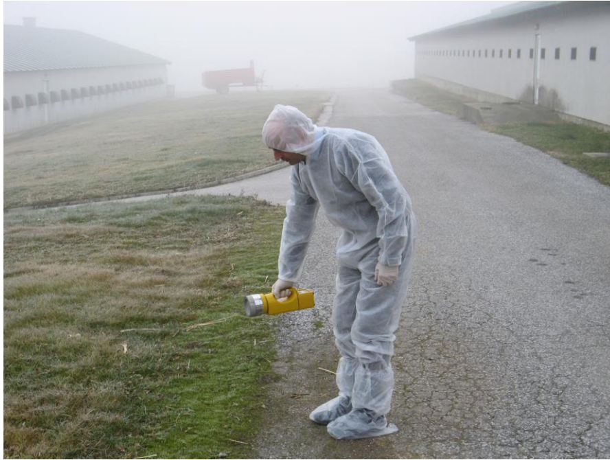
Slika 5. Uzorkovanje zraka izvan nastambe.
