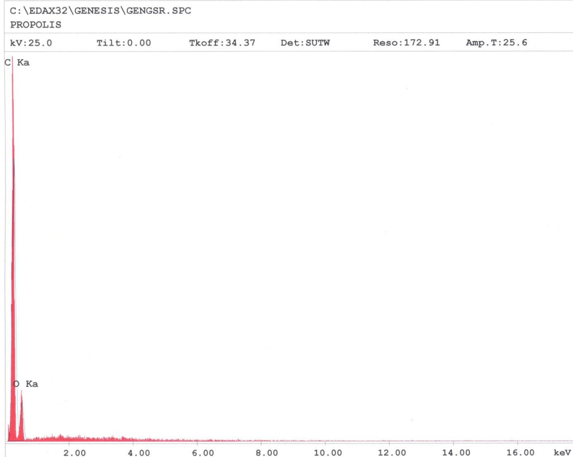
Slika 18 . Elementna kemijska analiza uzorka nativnog propolisa na prisustvo teških metale rađene na elektronskom mikroskopu SEM-u Philips XL 30 s EDX detektorom (EDAX), aktivne površine 10mm 2 (Centar za forenzična ispitivanja, istraživanja i vještačenja Ivan Vučetić, Zagreb, Hrvatska).
