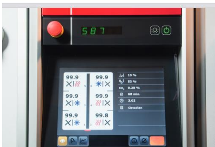
Slika 7. Prikaz ploče u inkubatorskoj jedinici za kontrolu mikroklimatskih uvjeta. Izvor:
