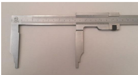
Slika 3. Pomična mjerka korištena za mjerenje papaka.
