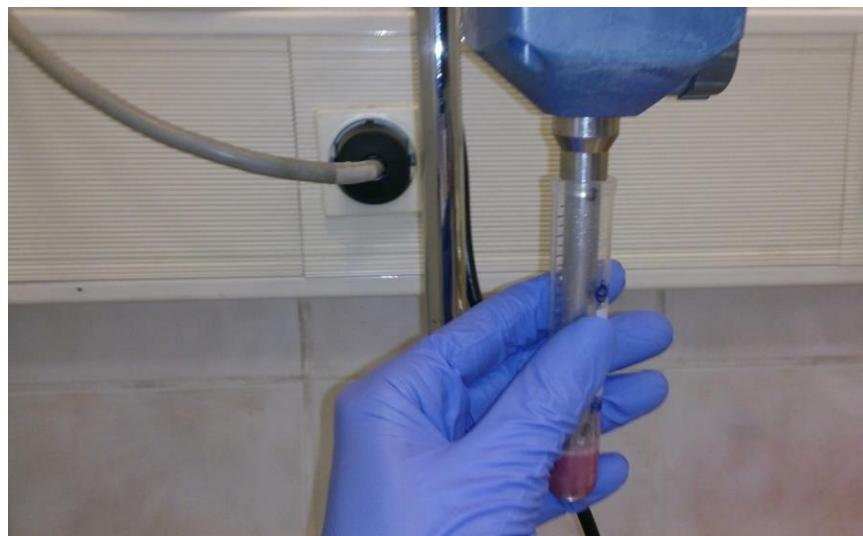
Slika 16. Homogenizacija uzorka.
